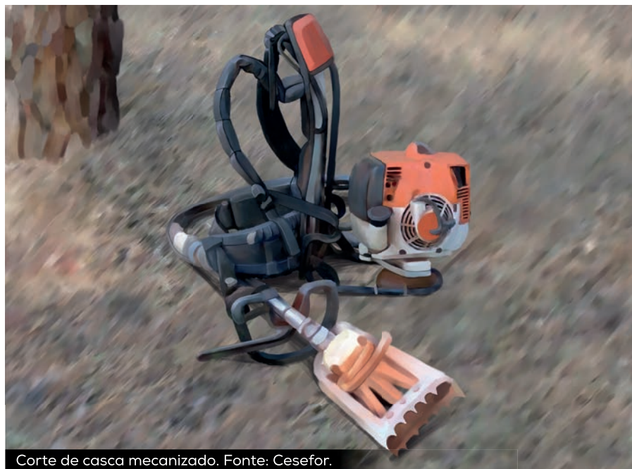
Corte de casca mecanizado. Fonte: Cesefor.
